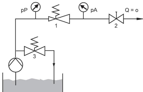
Wird das Absperrventil geöffnet, sinkt der Arbeitsdruck  $pA$  um den Betrag des Öffnungsdrucks  $pÖ$ .
