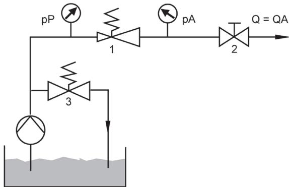
Wird das Absperrventil geschlossen, steigt der Arbeitsdruck  $pA$  um den Betrag des Schließdrucks  $pS$ .
